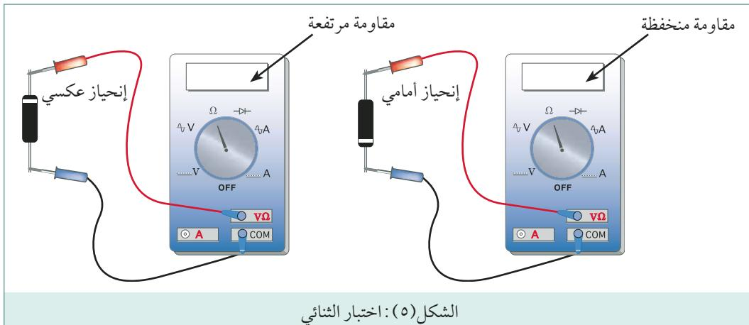
جهاز القياس الرقمي المتعدد القياسات (Digital Multimeter) الذي يمتلك ميزة اختبار الثنائي ، يعمل على قياس قيمة هبوط الجهد الأمامي بين طرفي الثنائي والتي تتراوح من  $0.1$  فولت لثنائي السليم ، لاحظ الشكل (٦).
